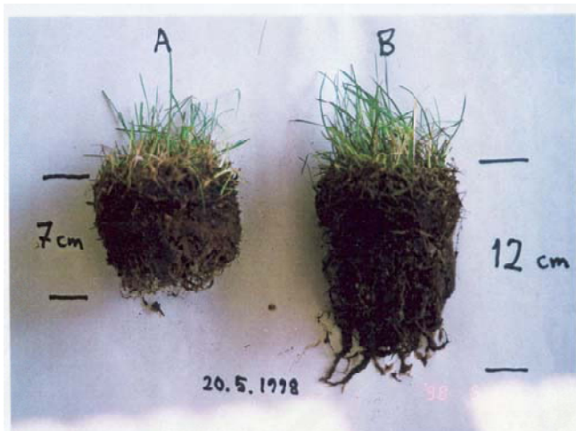
Fig. 5 Wortelstelsel in TerraCottem® – toplaag (rechts) en controletoplaag (links) (20.05.98)
