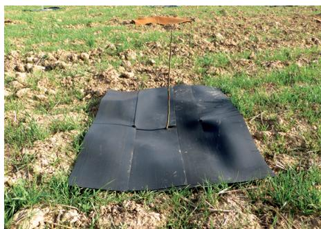
CUBIERTA DE GOMA RECICLADA, DE LARGA DURACIÓN O REUTILIZABLE, DE 1,5 MM DE GROSOR PARA NO REQUERIR FIJACIÓN AL SUELO (ECORUB)
